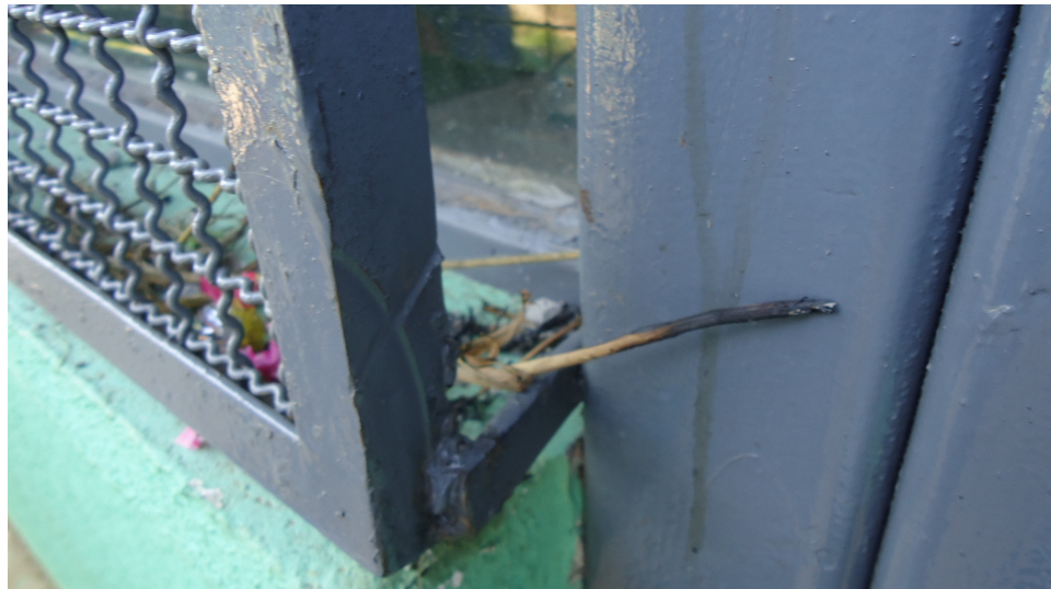
Figura 9: Fonte de ignição – chama aberta – gravetos com fogo posto Fonte: Laudo Técnico Pericial de Monica Bernardi Urias - Guarulhos/SP – 11/05/2011.
