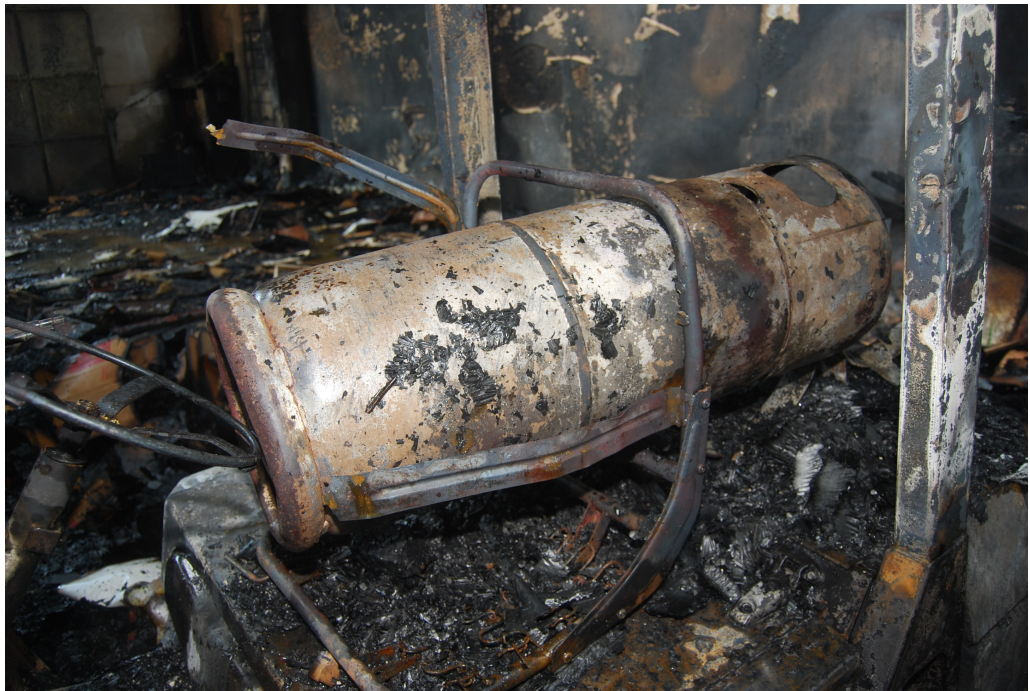
Figura 12: Explosão – deslocamento do tanque de gás da empilhadeira.
