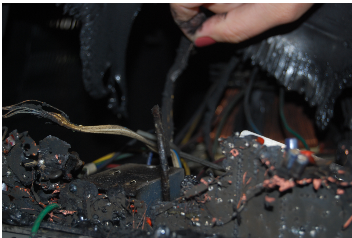
Figura 14: Pérola de fusão – fiação de televisor em curto-circuito. Fonte: Laudo Técnico Pericial de Monica Bernardi Urias - Arujá/SP – 19/03/2011.
